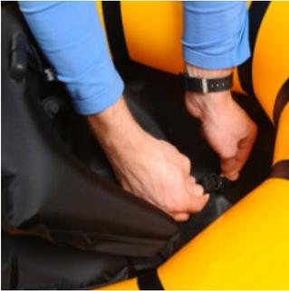
Der Sitz ist integraler Bestandteil des Bootes, welcher den Komfort und die Sicherheit erhöht. Er schützt vor Belastungen der Wirbelsäule und vor der Kälte des Wassers. Er dient ebenfalls als zusätzlicher Auftriebskörper, der im Fall eines Lecks im Schlauch das Boot vor dem Sinken schützt. Befestigen Sie deshalb den Sitz an der dafür vorgesehenen Lasche im Boot. Je nach Modell unterscheiden sich die Sitzanlagen in Form, Gewicht und Material.
